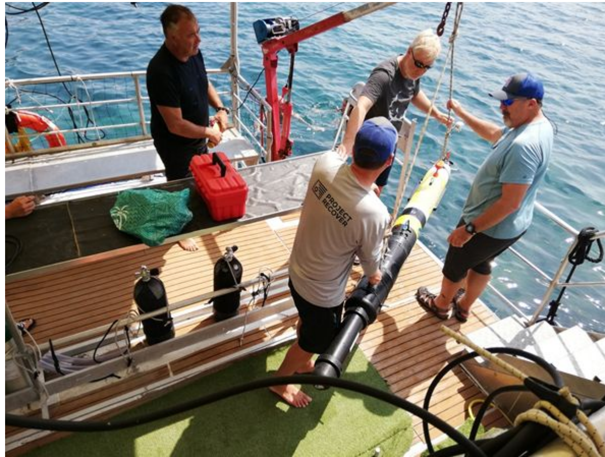
Članovi istraživačkog tima spuštaju AUV REMUS 100 u more s broda Manta ronilačkog centra, fotografija: Tea Katunarić Kirjakov
